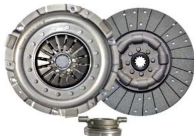
**Комплект сцепления с муфтой выключения сцепления****МТЗ 80,82 С/П Б/А****Применяемость:**
